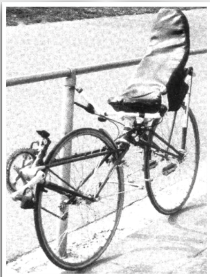
1. Vernieuwde voorwielaangedreven ChaCha van Willem van Wijnen (foto: Bernd Zwikker)
