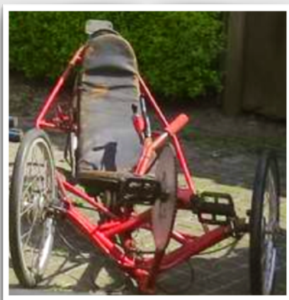
1. Vernieuwde voorwielaangedreven ChaCha van Willem van Wijnen (foto: Bernd Zwikker)
