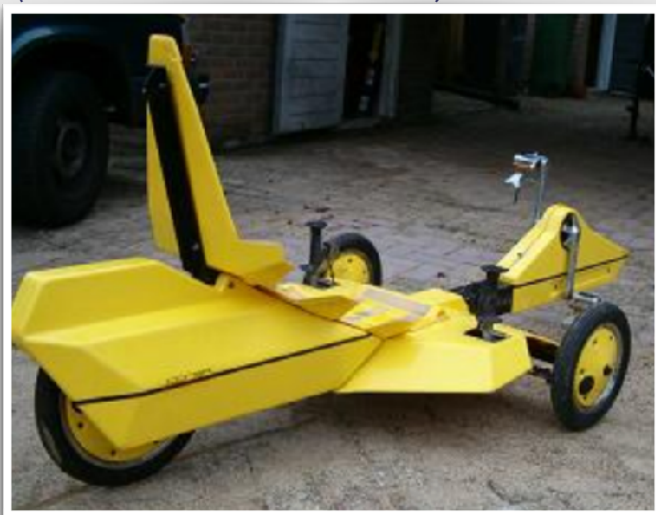
5. Nieuwste M5 van Bram Moens . Met bromfietsachtervering. Door stoeltje en bagagerekje samen uit één stuk te maken van kunststof, storen de logge veerbenen niet. (Foto: Wim van den Assum)
