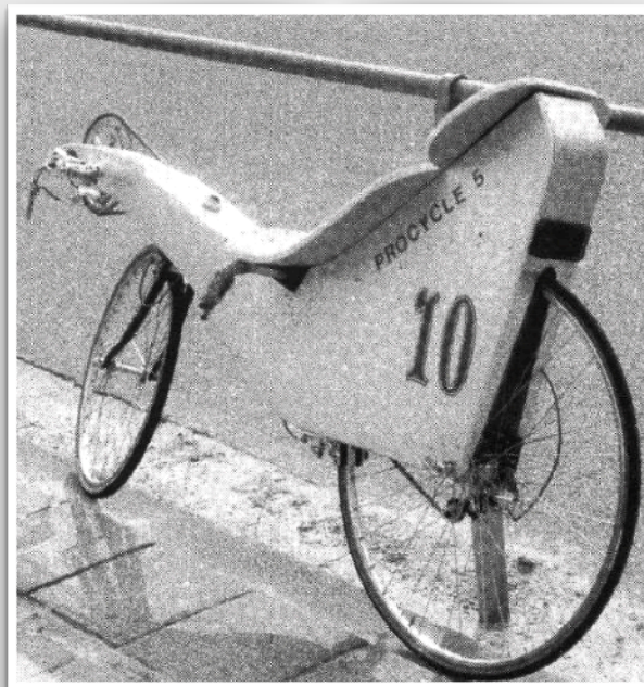
2. Nieuwste aluminium plaatfiets van Georg Steenberg . Nog strakker dan voorheen en een gewicht van slechts 10,5 kg. (foto: Bernd Zwikker)
