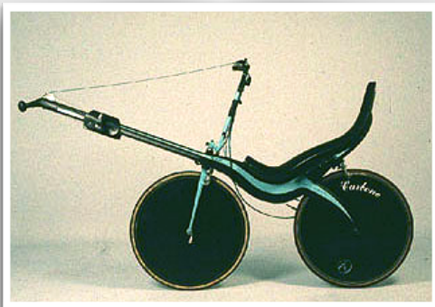
7. De Corsa Driewielige ligfiets, aluminium frame met kunststof opbouw in 1988 te koop bij leverancier Wim Kok
